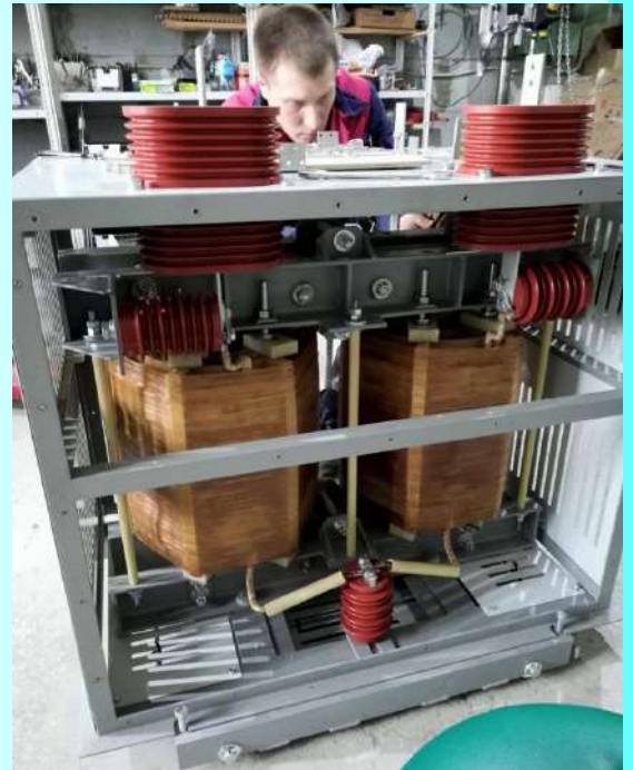
Изометрия трансформатора с шпильками для подъема
