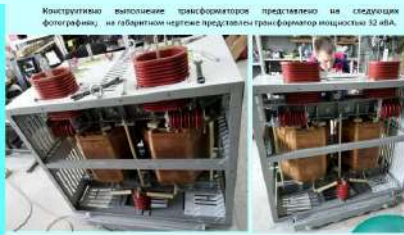
Конструктивно исполнение трансформаторов представлено на следующей фотографии на габаритном чертеже трансформатора мощностью 32 кВА.
